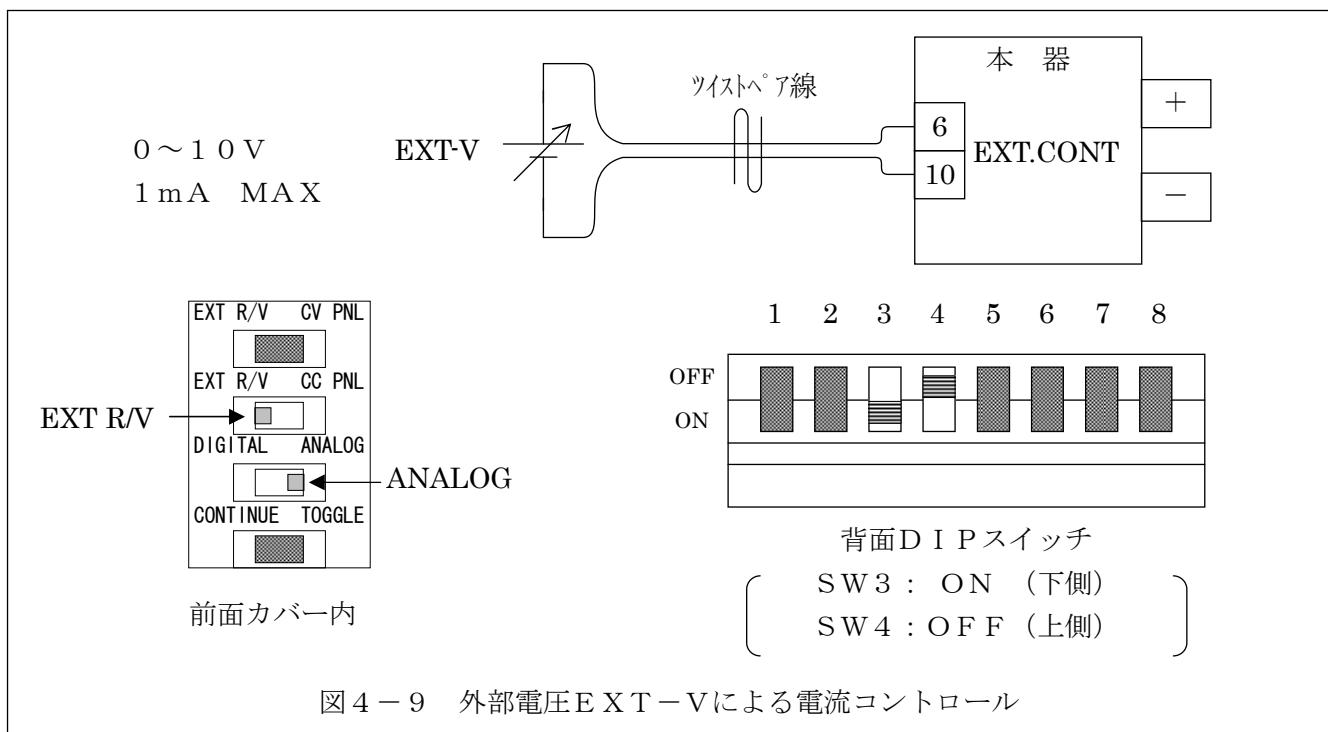
図4-9 外部電圧EXT-Vによる電流コントロール
