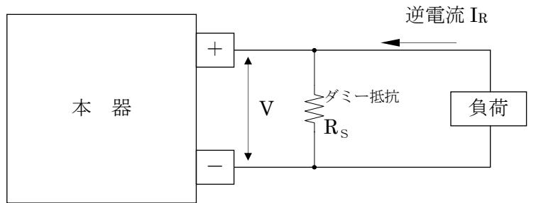
図5-4 ダミー抵抗による逆電流の吸收
