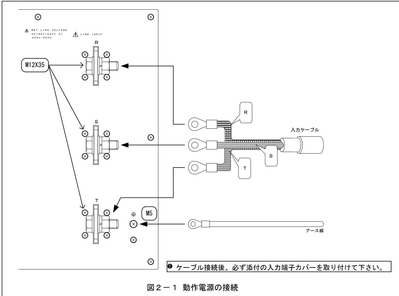
図2-1 動作電源の接続
