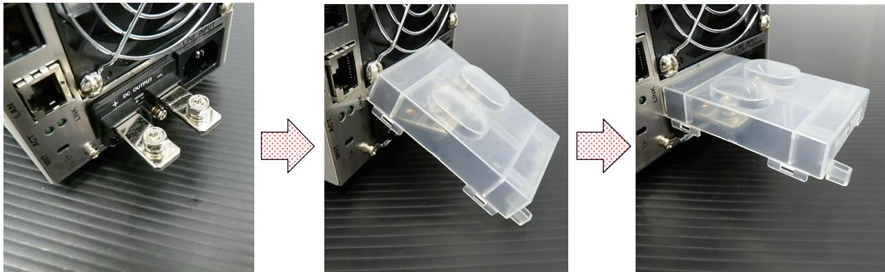
2. 端子カバーの残りの1個に固定用のサポート(端子カバーの内側センター部へ挿入)をカバーアーからM3×6mmビスで固定します。
