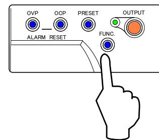
5. 「PRESET」キー①を押し「VOLTAGE」ツマミ②で「0.0V」に設定します。
