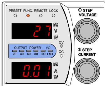
10. 出力電流計測用デジタルマルチメーターの表示(mV)と「数字表示器」下段に表示された計測値が同じになるように「CURRENT」ツマミを調整します。
