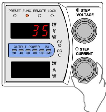
12. 「FUNC.」キーを押し、出力電流モニターのフルスケール校正を終了します。
