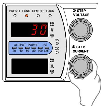
10. 「FUNC.」キーを押し、外部抵抗による出力電圧のコントロール(C)のオフセット校正を終了します。
