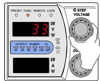
13. 「FUNC.」キーを押し、出力電圧モニターのフルスケール校正を終了します。
