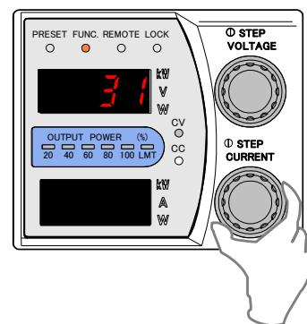
14. 「FUNC.」キーを押し、外部抵抗による出力電圧のコントロール(C)のオフセット校正を終了します。
