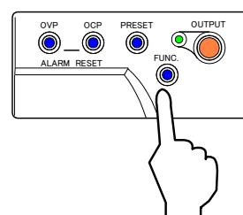
7. 「PRESET」キーを押し「CURRENT」ツマミで CC 設定値を「5.000」A(※)、「VOLTAGE」ツマミで CV 設定値を「1.00 V」に設定します。
