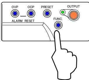
10. 「PRESET」キー①を押し「VOLTAGE」ツマミ②で「640.0V」に設定します。
