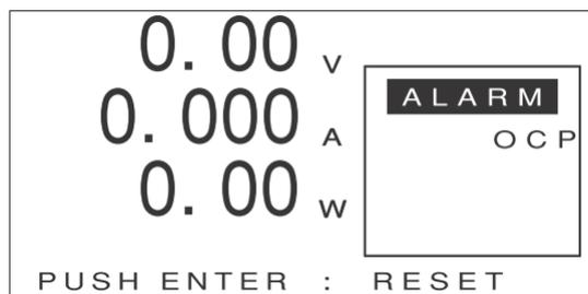
過電流の原因を取り除いた後、[ENTER]キーを押すと元の表示に戻ります。
