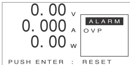
過電圧の原因を取り除いた後、[ENTER]キーを押すと元の表示に戻ります。
