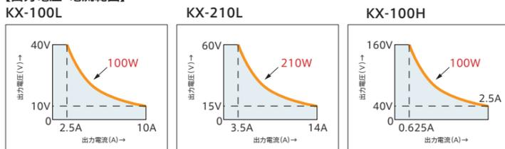
※1:ズーム方式とは、定電力形の出力範囲を持ち、電圧(電流)の低いところでは高い電流(電圧)を出力できるものです。
