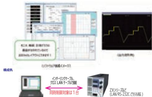
PC上のRS-232Cポート、LANポートを使用。PC/PLCにRS-232Cポートが無い場合は、USB-232C変換器などでRS-232Cポートを接続してください。
