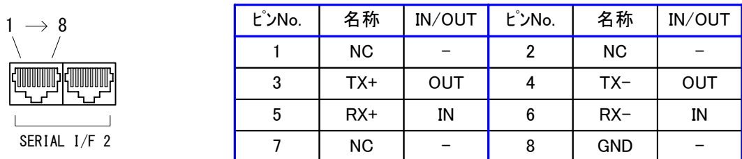
外部コントロールコネクタ「SERIAL I/F 2」ピン配置
