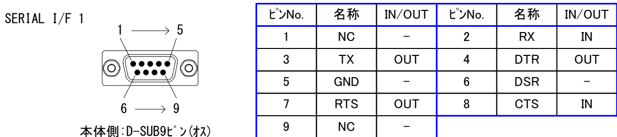
外部コントロールコネクタ「SERIAL I/F 1」ピン配置
