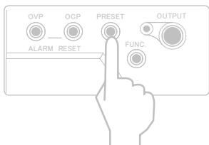
9. スレーブ機の「FUNC.」キーを押し「VOLTAGE」ツマミを回して「数字表示器」上段に設定項目番号 38 を表示させます。
