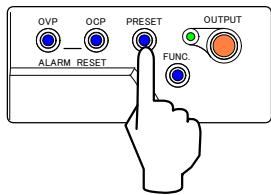
9. 「FUNC.」キーを押し「VOLTAGE」ツマミを回して「数字表示器」上段に設定項目番号 21 を表示させます。
