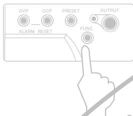
7. マスター機の「PRESET」キーを押し「VOLTAGE」ツマミにて「80.00」Vに設定します。
