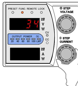
9. 「FUNC.」キーを押し、出力電流モニターのオフセット校正を終了します。
