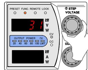
13. 出力電圧計測用デジタルマルチメーターの表示が設定値になるように「CURRENT」ツマミで調整します。
