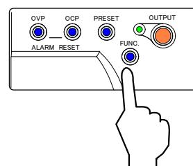
15. これで外部電圧による出力電圧コントロールのオフセット・フルスケール校正是終了です。
