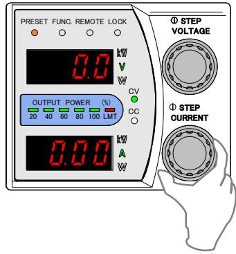
FUNCTION 項目番号 50 のパラメータが 0 のときは、再度「PRESET」キーを押してプリセット・モードから抜けたときに出力電流が更新されます。
