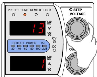
3. 「CURRENT」ツマミを回して設定値を0(直線性補正機能:OFF)にします。
