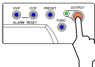
8. 「FUNC.」キーを押し「VOLTAGE」ツマミを回して「数字表示器」上段に設定項目30を表示させます。
