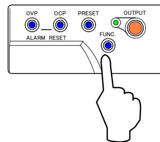
5. 「PRESET」キー①を押し「VOLTAGE」ツマミ②で「0.0V」に設定します。
