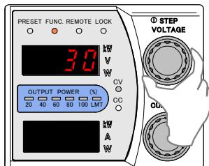
9. 出力電流計測用デジタルマルチメーターの表示が設定値になるように「CURRENT」ツマミで調整します。
