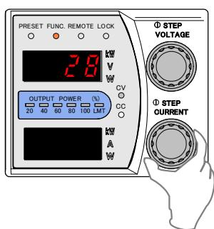
10. 「FUNC.」キーを押し、外部抵抗による出力電圧のコントロール(B)のオフセット校正を終了します。
