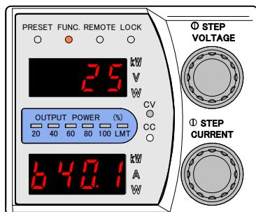
10. 出力電圧計測用デジタルマルチメーターの表示と「数字表示器」下段に表示された計測値が同じになるように「CURRENT」ツマミを調整します。
