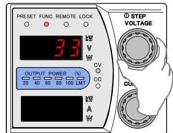
12. 電圧モニター計測用デジタルマルチメーターの表示が「出力電圧/8」になるように「CURRENT」ツマミで調整します。
