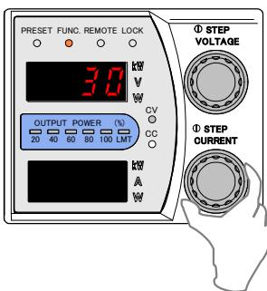
10. 「FUNC.」キーを押し、外部電圧による出力電流のコントロールのオフセット校正を終了します。
