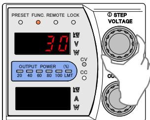
9. 出力電流計測用デジタルマルチメーターの表示が設定値になるように「CURRENT」ツマミで調整します。
