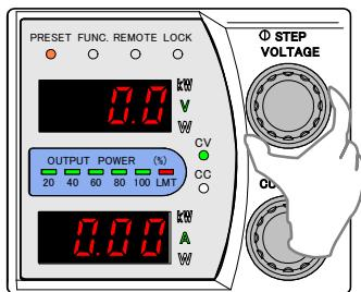
FUNCTION 項目番号 50 のパラメータが 0 のときは、再度「PRESET」キーを押してプリセット・モードから抜けたときに出力電圧が更新されます。
