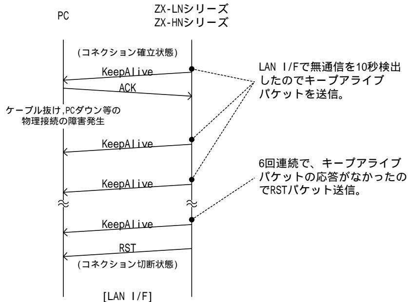
(図 . キープアライブパケットによる物理接続監視 )
