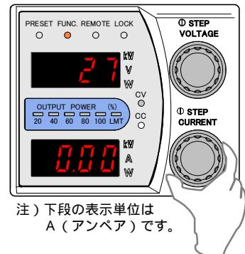
11. 「FUNC.」キーを押し、電流計のフルスケール校正を終了させます。
