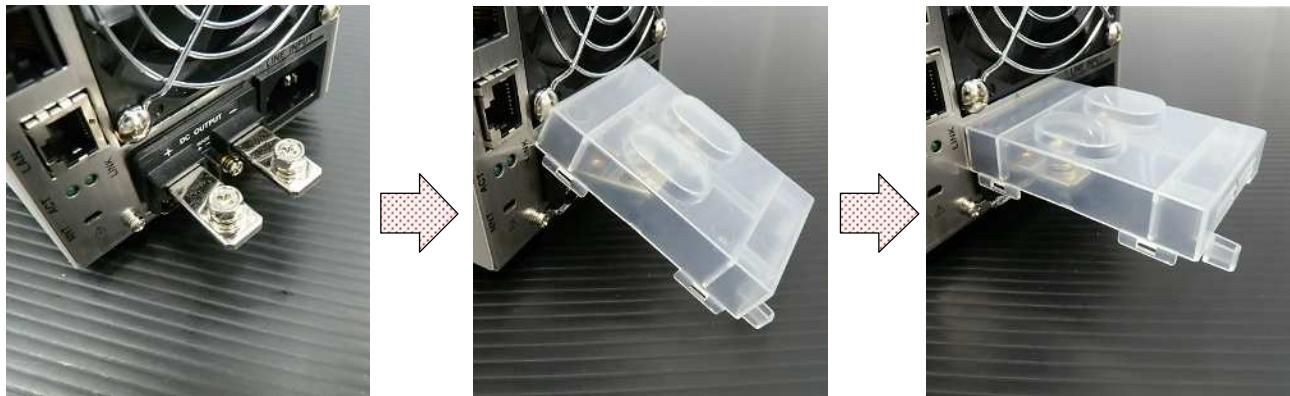
2. 端子カバーの残りの1個に固定用のサポート(端子カバーの内側センター部へ挿入)をカバーアンダからM3×6mmビスで固定します。
