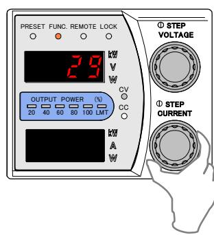
14. 「FUNC.」キーを押し、外部抵抗による出力電圧のコントロール(B)のフルスケール校正を終了します。
