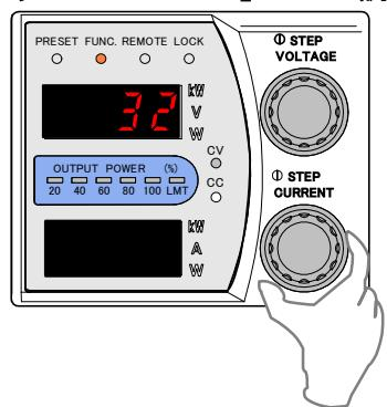
9. 「FUNC.」キーを押し、出力電圧モニターのオフセット校正を終了します。
