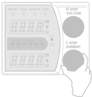
6. スレーブ機の「FUNC.」キーを押し、出力電圧設定のオフセット校正を終了させます。
