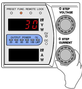
10. 「FUNC.」キーを押し、外部抵抗による出力電圧のコントロール(B)のオフセット校正を終了します。
