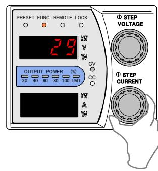
14. 「FUNC.」キーを押し、外部抵抗による出力電圧のコントロール(C)のフルスケール校正を終了します。
