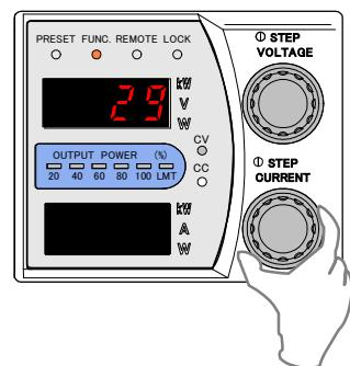
14. 「FUNC.」キーを押し、外部抵抗による出力電圧のコントロール(B)のフルスケール校正を終了します。
