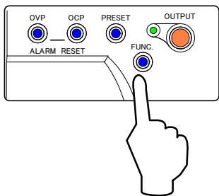
10. 「FUNC.」キーを押し「VOLTAGE」ツマミを回して「数字表示器」上段に設定項目35を表示させます。
