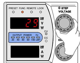
13. 出力電圧計測用デジタルマルチメーターの表示が「320.0V」になるように「CURRENT」ツマミで調整します。
