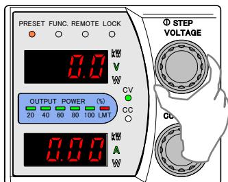
FUNCTION 項目番号 50 のパラメータが 0 のときは、再度「PRESET」キーを押してプリセット・モードから抜けたときに出力電圧が更新されます。
