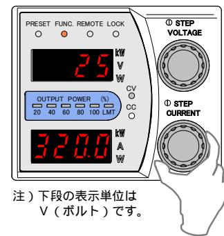
11. 「FUNC.」キーを押し、電圧計のフルスケール校正を終了させます。
