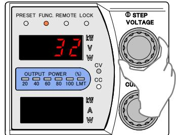
8. 電圧モニター計測用デジタルマルチメーターの表示が「0.0V」になるように「CURRENT」ツマミで調整します。
