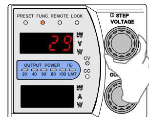
13. 出力電圧計測用デジタルマルチメーターの表示が640.0V になるように「CURRENT」ツマミで調整します。
