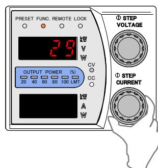
14. 「FUNC.」キーを押し、外部電圧による出力電圧のコントロールのフルスケール校正を終了します。
