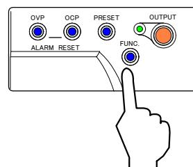
7. 「PRESET」キーを押し「CURRENT」ツマミで CC 設定値を「5.000」A(※)、「VOLTAGE」ツマミで CV 設定値を「1.0 V」に設定します。
