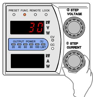
10. 「FUNC.」キーを押し、外部抵抗による出力電圧のコントロール(A)のオフセット校正を終了します。
