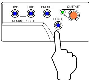
10. 「PRESET」キー①を押し「VOLTAGE」ツマミ②で「320.0V」に設定します。
