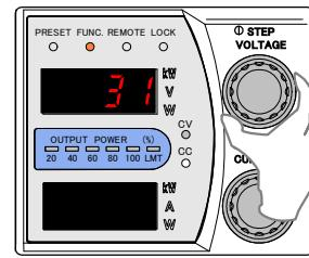
13. 出力電流計測用デジタルマルチメーターの表示が設定値になるように「CURRENT」ツマミで調整します。
