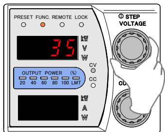
11. 電流モニター計測用デジタルマルチメーターの表示が「出力電流×2」(※)になるように「CURRENT」ツマミで調整します。
