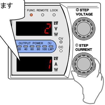
設定が終了したら再度「FUNC.」を押し設定を完了します。
