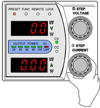
FUNCTION 項目番号 50 のパラメータが 0 のときは、再度「PRESET」キーを押してプリセット・モードから抜けたときに出力電流が更新されます。
