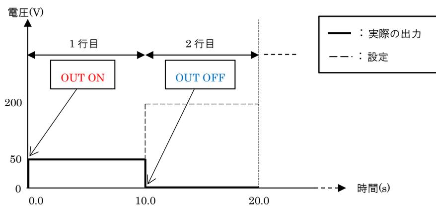
図 8-11 OUT OFF 動作例(定電圧モード(CV)設定時)
