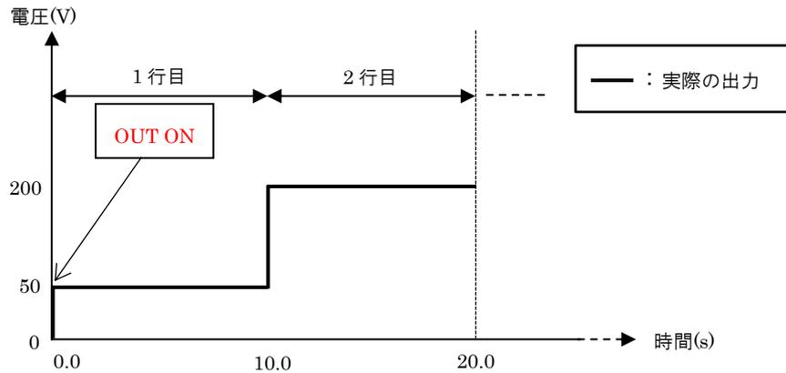
図 8-9 ステップ動作例(定電圧モード(CV)設定時)
