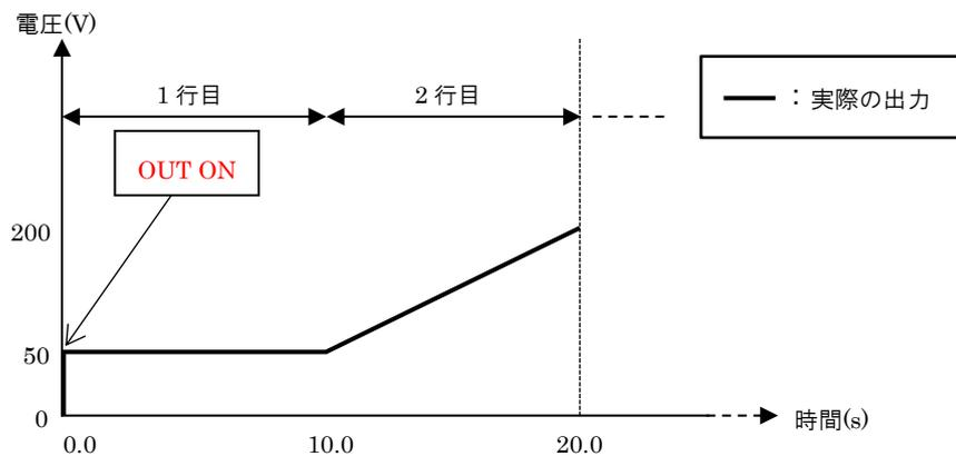
図 8-10 スイープ動作例(定電圧モード(CV)設定時)
