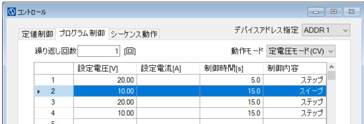
図 11-2 (例)プログラム制御行の選択
