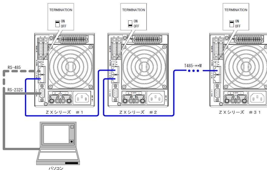
図 6-2 マルチ接続図(RS-232C 搭載タイプ)
