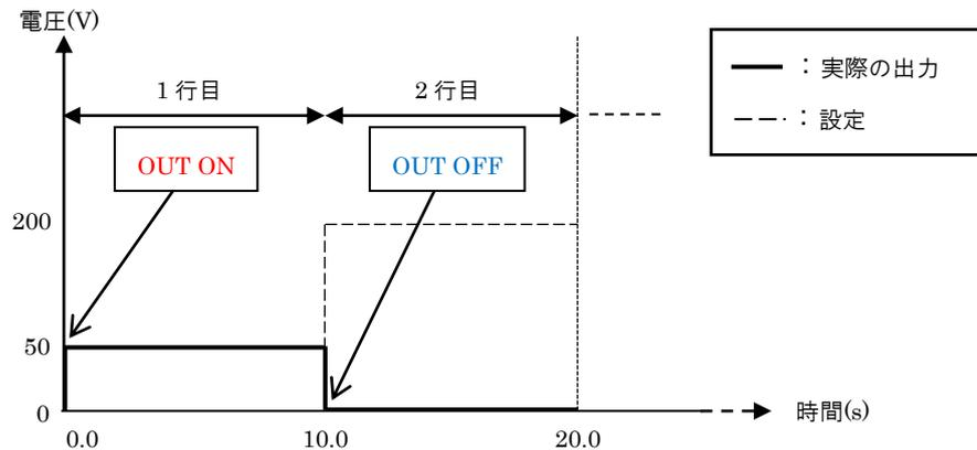
図 8-13 OUT OFF 動作例(定電圧モード(CV)設定時)
