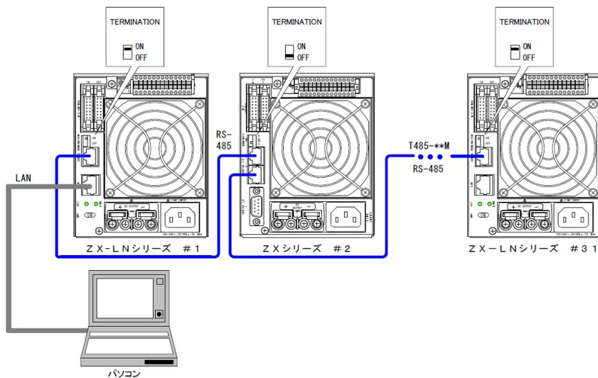
図 6-1 マルチ接続図(LAN 搭載タイプ)
