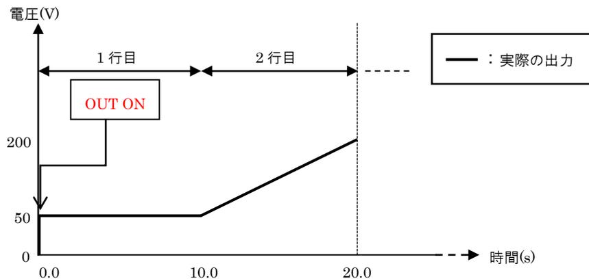
図 8-12 スイープ動作例(定電圧モード(CV)設定時)
