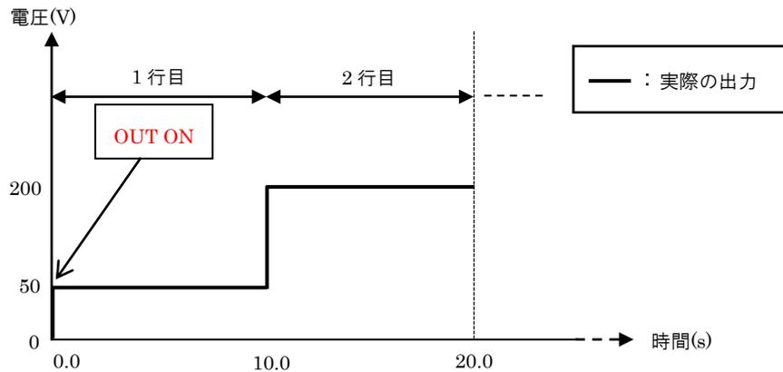
図 8-11 ステップ動作例(定電圧モード(CV)設定時)
