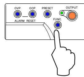
7. 「PRESET」キーを押し「VOLTAGE」ツマミにて CV 設定値を「320.0」Vに設定します。
