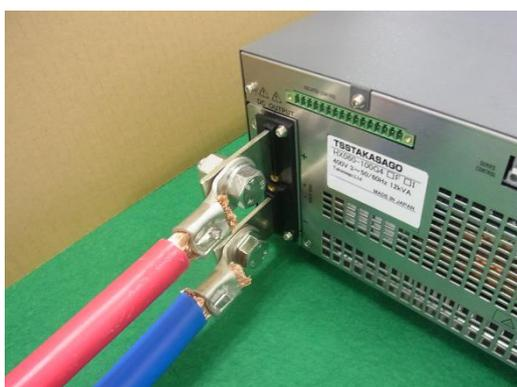
3. 出力ケーブルに出力端子用保護チューブを被せてインシュロックにて固定する。
