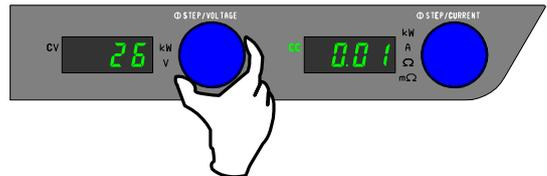
※その際「数字表示機(電流)」には電流計側値が表示されます。
