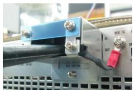
並列ケーブル接続時は端子カバーをつけ、アース線を FG 端子に取り付けてください。
