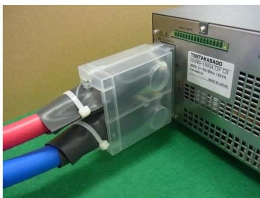
6. 出力端子カバーをM3×6mmビスで固定し、出力端子カバーの取り付け完了です。
