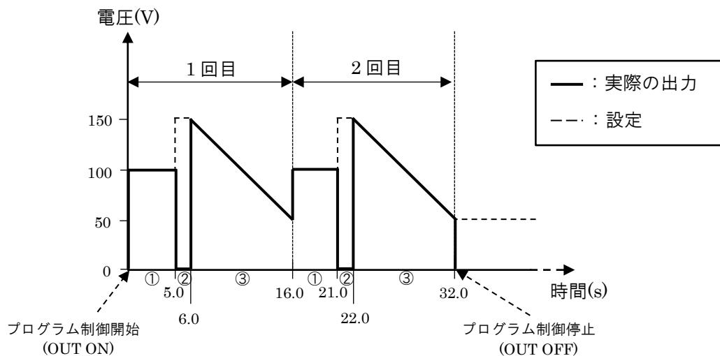
図 7-13 プログラム制御実行結果例
