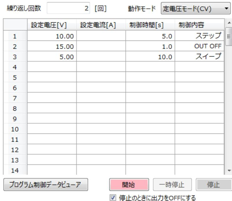
図 7-12 プログラム制御データ設定例
