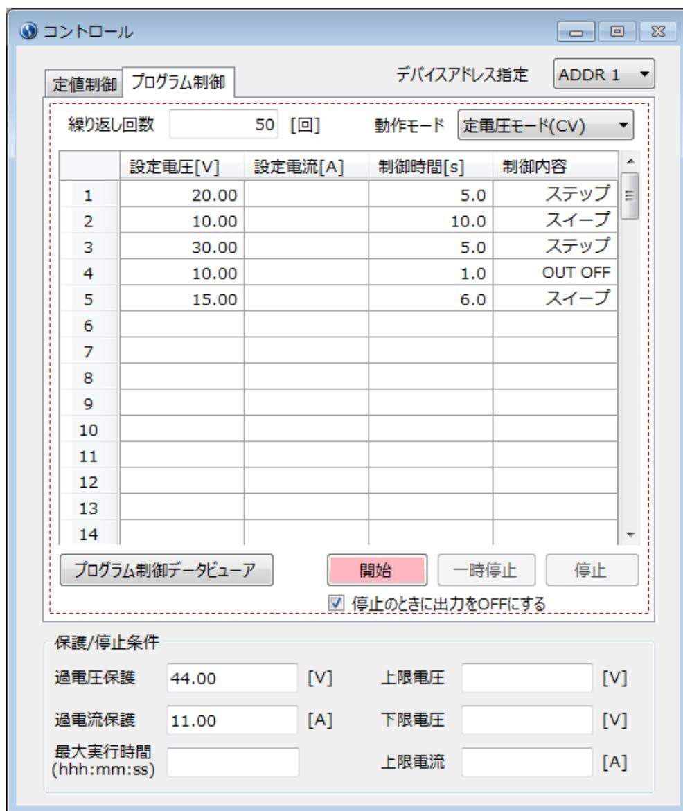
図 7-1 プログラム制御データ入力欄
