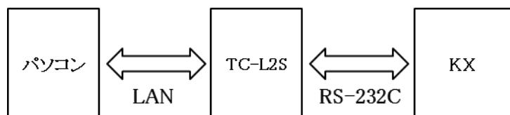
図 2-2 接続構成図(LAN 通信)
