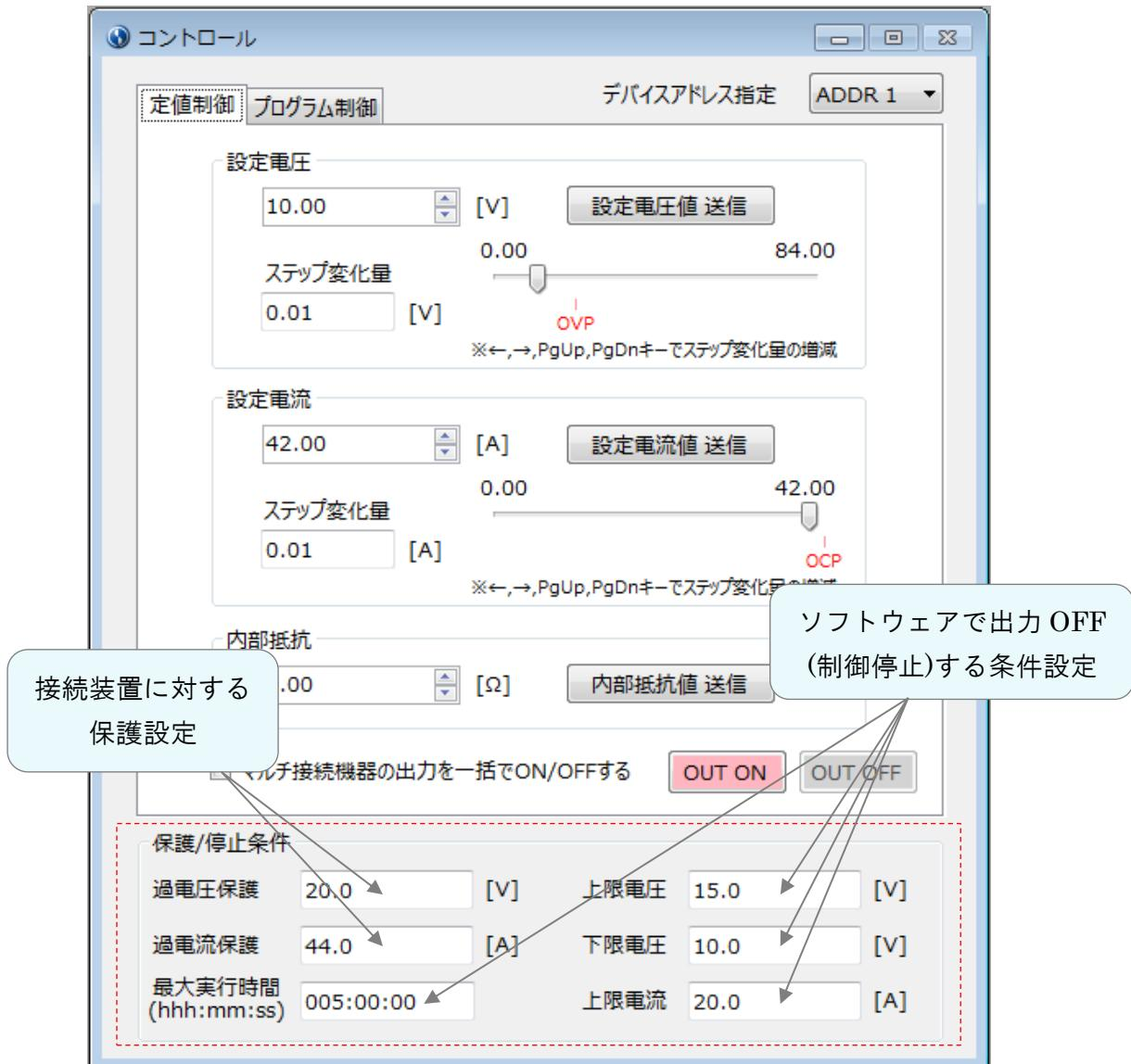
保護/停止条件は、定値制御またはプログラム制御中の装置のステータスを監視し、条件を満たした場合に出力を停止する機能です。
