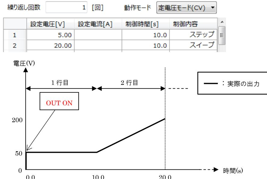
図 7-10 スイープ動作例(定電圧モード(CV)設定時)
