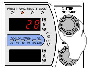
9. 出力電流計測用デジタルマルチメーターの表示が「0.00V」になるように「CURRENT」ツマミで調整します。
