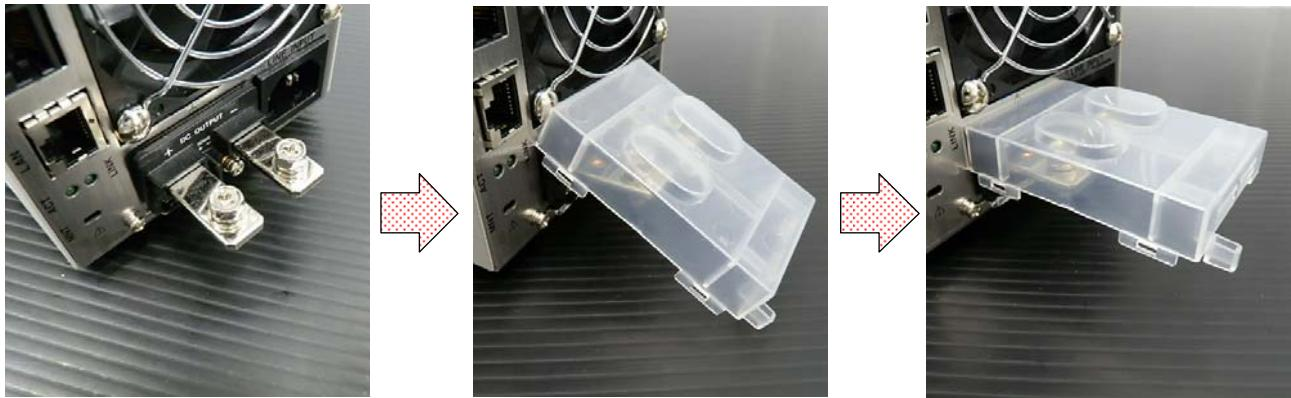
2. 端子カバーの残りの1個に固定用のサポート(端子カバーの内側センター部へ挿入)をカバーアンダーフロムからM3×6mmビスで固定します。
