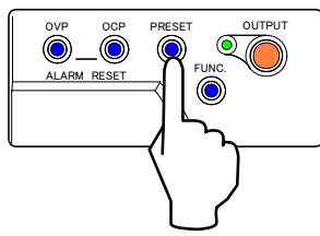
9. 「FUNC.」キーを押し「VOLTAGE」ツマミを回して「数字表示器」上段に設定項目番号 25 を表示させ、下段に電圧計測値を表示させます。
