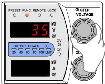
11. 電流モニター計測用デジタルマルチメーターの表示が「出力電流/4」(※)になるように「CURRENT」ツマミで調整します。
