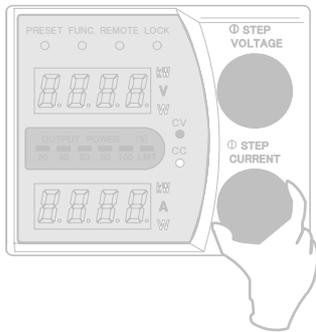
9. スレーブ機の「FUNC.」キーを押し「VOLTAGE」ツマミを回して「数字表示器」上段に設定項目番号 38 を表示させます。
