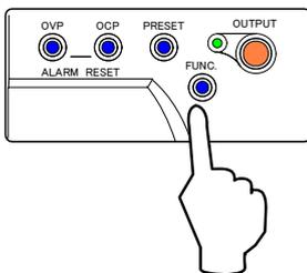
14. 「FUNC.」キーを押し、外部抵抗による出力電圧のコントロール(C)のフルスケール校正を終了します。
