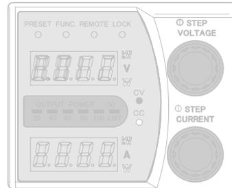
6. スレーブ機の「FUNC.」キーを押し、出力電圧設定のオフセット校正を終了させます。
