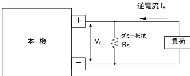
$$R_S < \frac{V_0}{I_R} \text{ とする}$$
