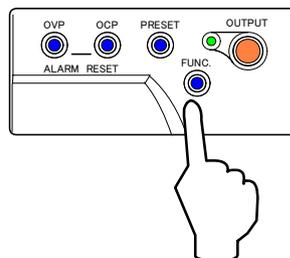
5. 「OVP」キー①を押し「VOLTAGE」つまみ②で「704.0V」に設定します。
