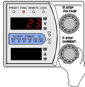
11. 「FUNC.」キーを押し、出力電流設定のフルスケール校正を終了させます。
