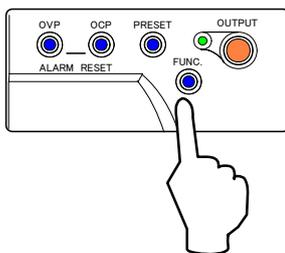
14. 「FUNC.」キーを押し、外部電圧による出力電圧のコントロールのフルスケール校正を終了します。
