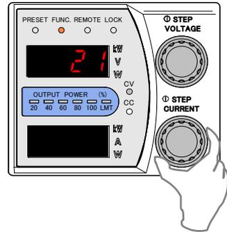
11. 「FUNC.」キーを押し、出力電圧設定のフルスケール校正を終了させます。
