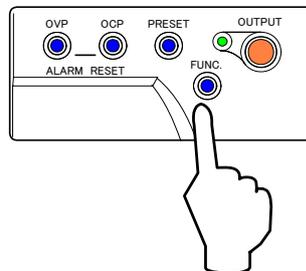
5. 「OVP」キーを押し「VOLTAGE」ツマミで「704.0V」に設定します。
