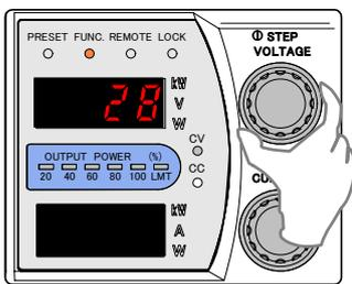
12. 「FUNC.」キーを押し「VOLTAGE」つまみを回して「数字表示器」上段に設定項目29を表示させます。
