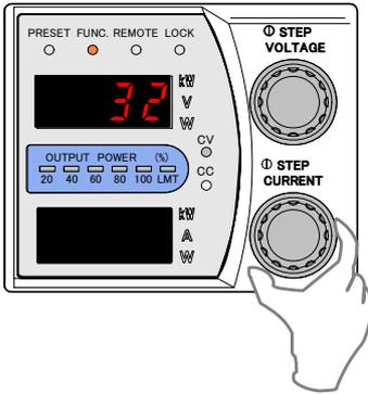
12. 電圧モニター計測用デジタルマルチメーターの表示が「出力電圧/8」になるように「CURRENT」つまみで調整します。
