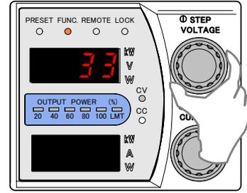
8. 電圧モニター計測用デジタルマルチメーターの表示が「0.0V」になるように「CURRENT」つまみで調整します。
