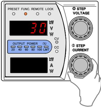
13. 出力電流計測用デジタルマルチメーターの表示が設定値になるように「CURRENT」ツマミで調整します。
