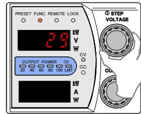
9. 出力電流計測用デジタルマルチメーターの表示が「0.00V」になるように「CURRENT」ツマミで調整します。
