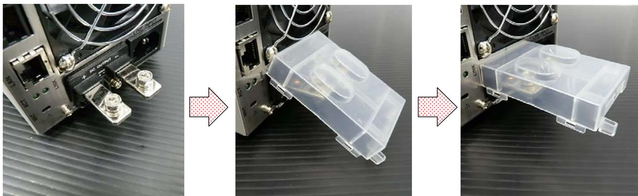
2. 端子カバーの残りの1個に固定用のサポート(端子カバーの内側センター部へ挿入)をカバー下からM3×6mmビスで固定します。
