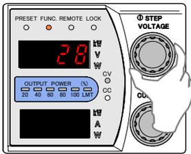
12. 「FUNC.」キーを押し「VOLTAGE」ツマミを回して「数字表示器」上段に設定項目29を表示させます。
