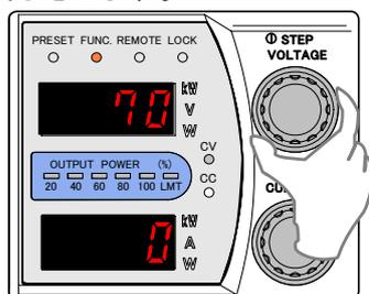
3. 「CURRENT」ツマミを回して設定値を3(外部抵抗B)に変更します。
