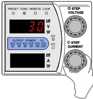
10. 「FUNC.」キーを押し、外部電圧による出力電流のコントロールのオフセット校正を終了します。
