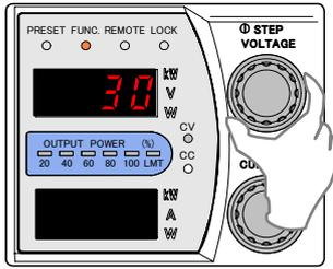
12. 「FUNC.」キーを押し「VOLTAGE」ツマミを回して「数字表示器」上段に設定項目31を表示させます。
