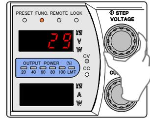
9. 出力電圧計測用デジタルマルチメーターの表示が「0.00V」になるように「CURRENT」ツマミで調整します。
