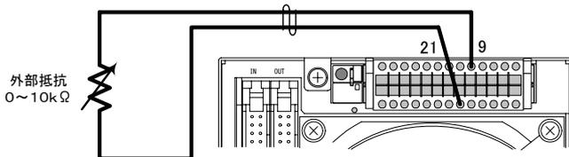
17. これで外部抵抗による出力電圧コントロール(B)のオフセット・フルスケール校正は終了です。
