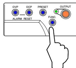
7. 「PRESET」キーを押し「VOLTAGE」ツマミにて「640.0」Vに設定します。
