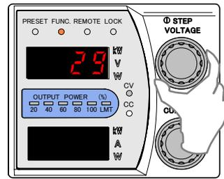
9. 出力電圧計測用デジタルマルチメーターの表示が「0.00V」になるように「CURRENT」ツマミで調整します。
