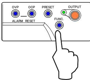
14. 「FUNC.」キーを押し、外部抵抗による出力電圧のコントロール(A)のオフセット校正を終了します。
