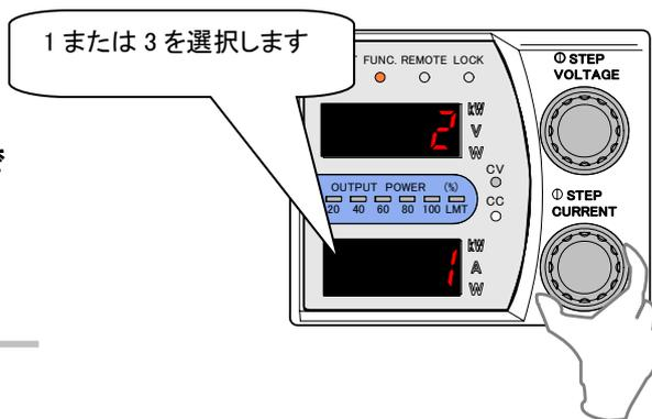
設定が終了したら再度「FUNC.」を押し設定を完了します。
