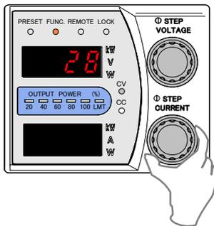
13. 出力電圧計測用デジタルマルチメーターの表示が640.0Vになるように「CURRENT」つまみで調整します。
