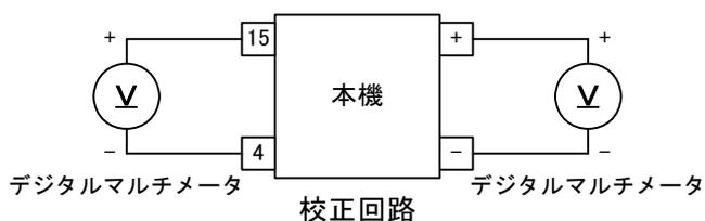
2. 「FUNC.」キーを押し「VOLTAGE」つまみを回して「数字表示器」上段に設定項目13を表示させます。
