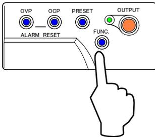
13. 「FUNC.」キーを押し、出力電圧モニターのフルスケール校正を終了します。
