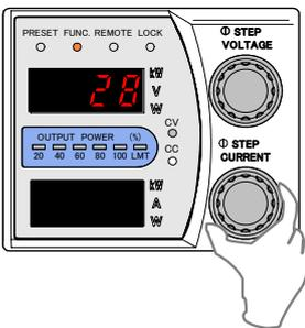
13. 出力電圧計測用デジタルマルチメーターの表示が640.0Vになるように「CURRENT」ツマミで調整します。
