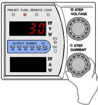
13. 出力電圧計測用デジタルマルチメーターの表示が設定値になるように「CURRENT」ツマミで調整します。
