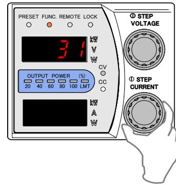
14. 「FUNC.」キーを押し、外部電圧による出力電流のコントロールのフルスケール校正を終了します。
