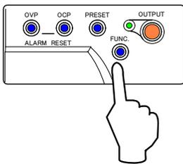
14. 「FUNC.」キーを押し、外部抵抗による出力電圧のコントロール(B)のフルスケール校正を終了します。
