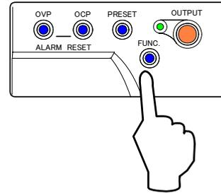
10. 「FUNC.」キーを押し「VOLTAGE」ツマミを回して「数字表示器」上段に設定項目35を表示させます。
