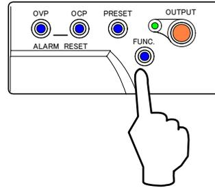
12. これで電圧計の校正が完了しました。CV設定値を元に戻して使用してください。
