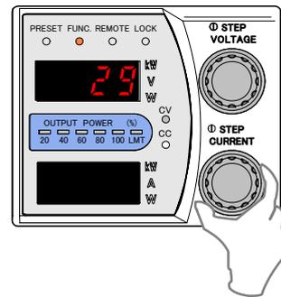
10. 「FUNC.」キーを押し、外部電圧による出力電圧のコントロールのオフセット校正を終了します。
