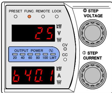
10. 出力電圧計測用デジタルマルチメーターの表示と「数字表示器」下段に表示された計測値が同じになるように「CURRENT」つまみを調整します。
