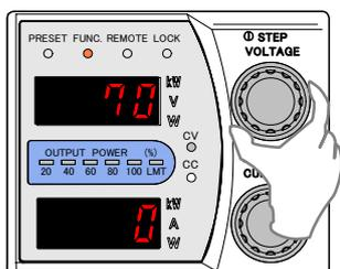
3. 「CURRENT」ツマミを回して設定値を4(外部抵抗 C)に変更します。
