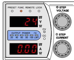
5. 出力電圧計測用デジタルマルチメーターの表示と「数字表示器」下段に表示された計測値が同じになるように「CURRENT」ツマミを調整します。
