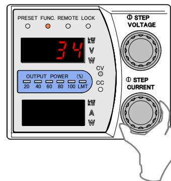
9. 「FUNC.」キーを押し、出力電流モニターのオフセット校正を終了します。
