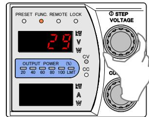
9. 出力電圧計測用デジタルマルチメーターの表示が「0.00 V」になるように「CURRENT」つまみで調整します。
