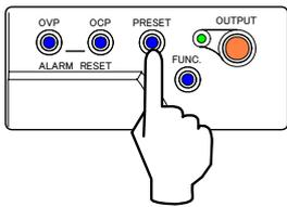
9. 「FUNC.」キーを押し「VOLTAGE」ツマミを回して「数字表示器」上段に設定項目番号 23 を表示させます。
