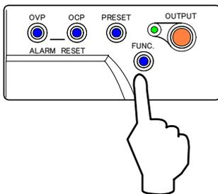
14. 「FUNC.」キーを押し、外部抵抗による出力電圧のコントロール(B)のオフセット校正を終了します。
