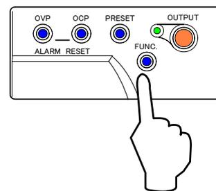
「PRESET」キーを押し「CURRENT」ツマミで充電電流を設定します。
