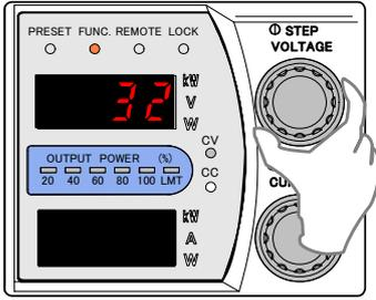
11. 「FUNC.」キーを押し「VOLTAGE」つまみを回して「数字表示器」上段に設定項目33を表示させます。
