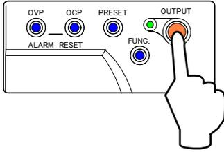
8. 「FUNC.」キーを押し「VOLTAGE」ツマミを回して「数字表示器」上段に設定項目30を表示させます。
