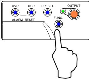
14. 「FUNC.」キーを押し、外部抵抗による出力電圧のコントロール(C)のオフセット校正を終了します。
