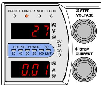
10. 出力電流計測用デジタルマルチメーターの表示(mV)と「数字表示器」下段に表示された計測値が同じになるように「CURRENT」ツマミを調整します。
