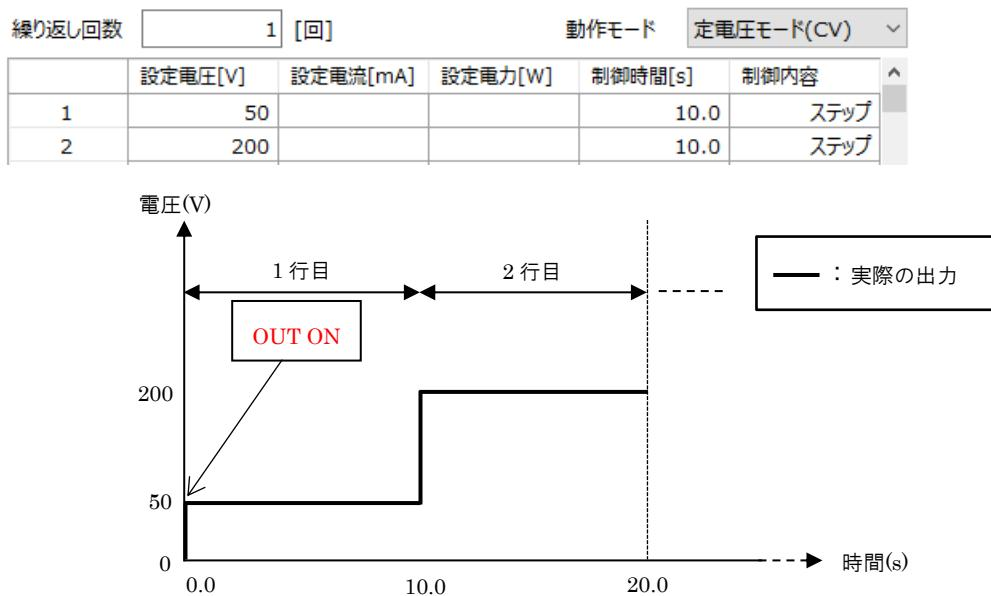
図 8-11 ステップ動作例(定電圧モード(CV)設定時)
