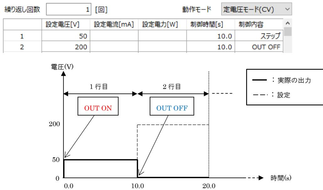
図 8-13 OUT OFF 動作例(定電圧モード(CV)設定時)
