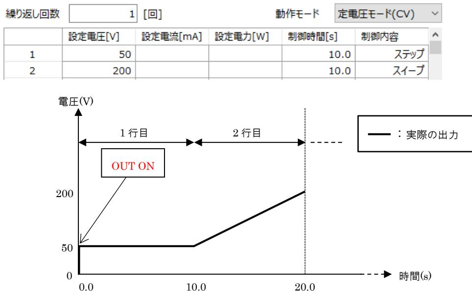
図 8-12 スイープ動作例(定電圧モード(CV)設定時)
