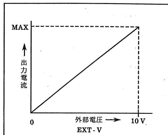
$$\text{出力電流 (A)} = \frac{\text{外部電圧 (V)}}{10} \times \text{最大出力電流 (A)} \quad (6)$$
