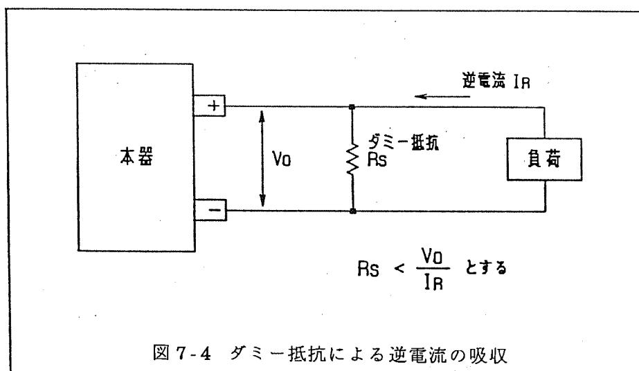
図7-4 ダミー抵抗による逆電流の吸収
