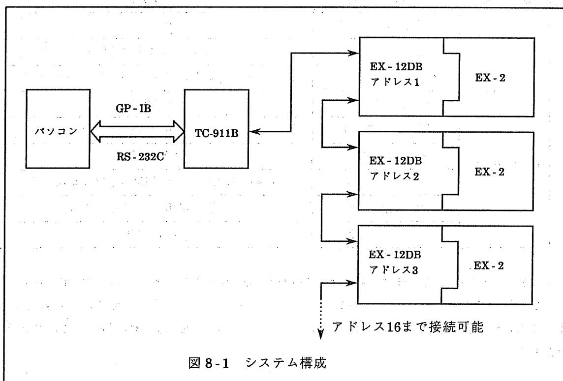
DA-AD ボード EX-12DB は、EX-2 シリーズ電源のスロットに実装されます。実装作業はユーザーで行うことができます。EX-12DB には 12 ビット D/A コンバータ 2 チャンネル、8 ビット D/A コンバータ 2 チャンネル、マルチプレクサ付 12 ビット A/D コンバータ 1 チャンネルが内蔵されており、出力パラメータの設定、出力電圧、電流の測定と設定値の読み出しが可能です。
