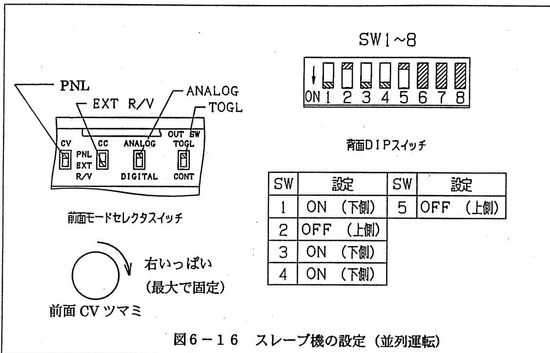
出力電圧、出力電流のコントロール、出力の ON-OFF、OVP、OCP の設定はマスター機でおこなうことができます。
