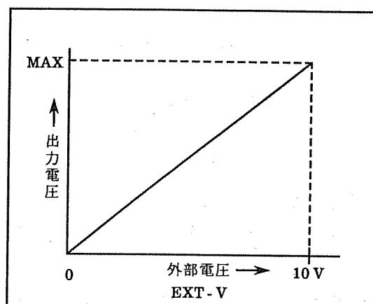
$$\text{出力電圧 (V)} = \frac{\text{最大出力電圧 (V)}}{10} \quad (3)$$
