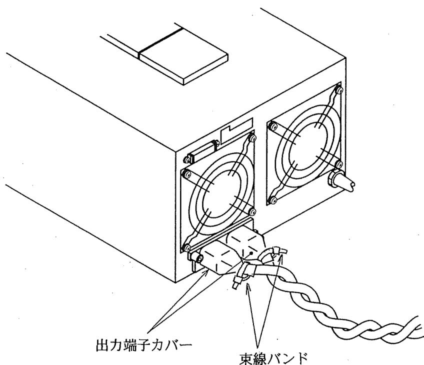
図4-3 出力端子カバーの取り付け
