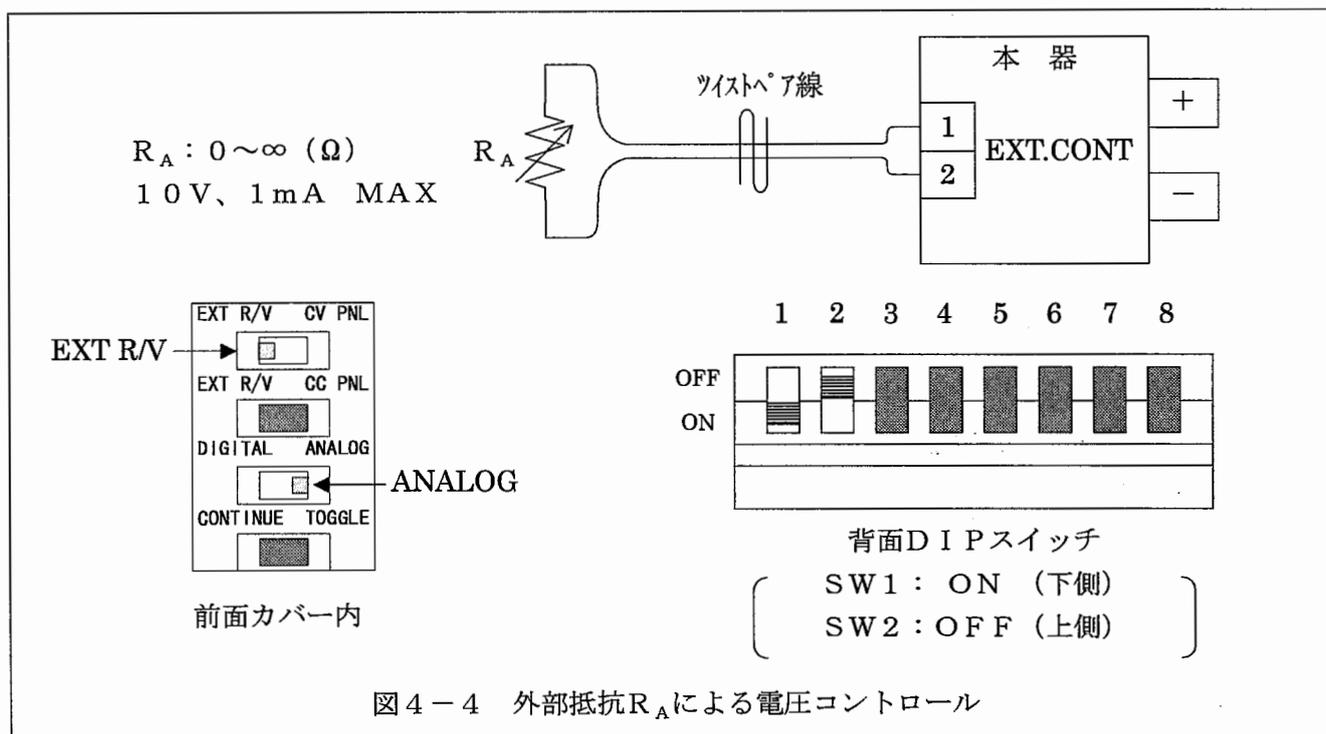
図4-4 外部抵抗 $R_A$ による電圧コントロール
