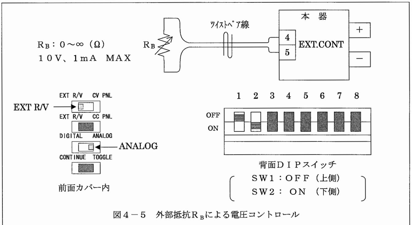
図4-5 外部抵抗R<sub>B</sub>による電圧コントロール
