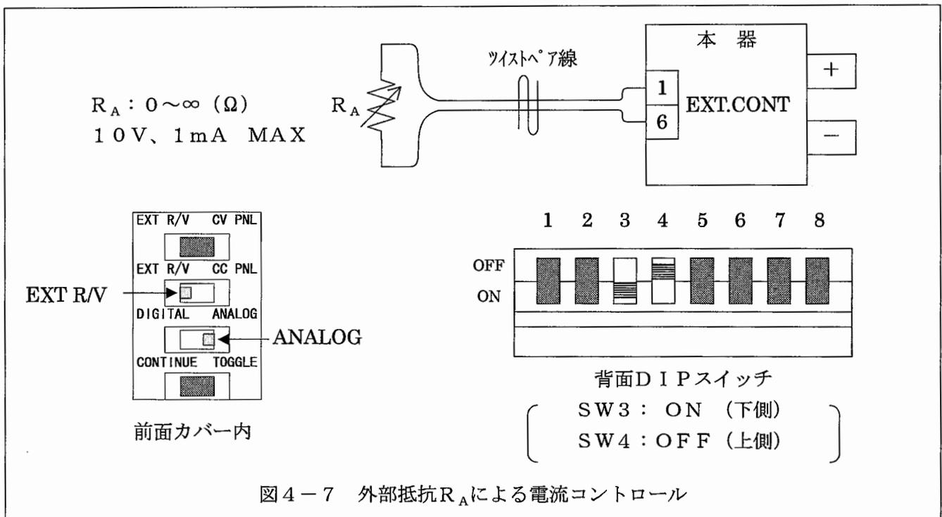
図4-7 外部抵抗RAによる電流コントロール
