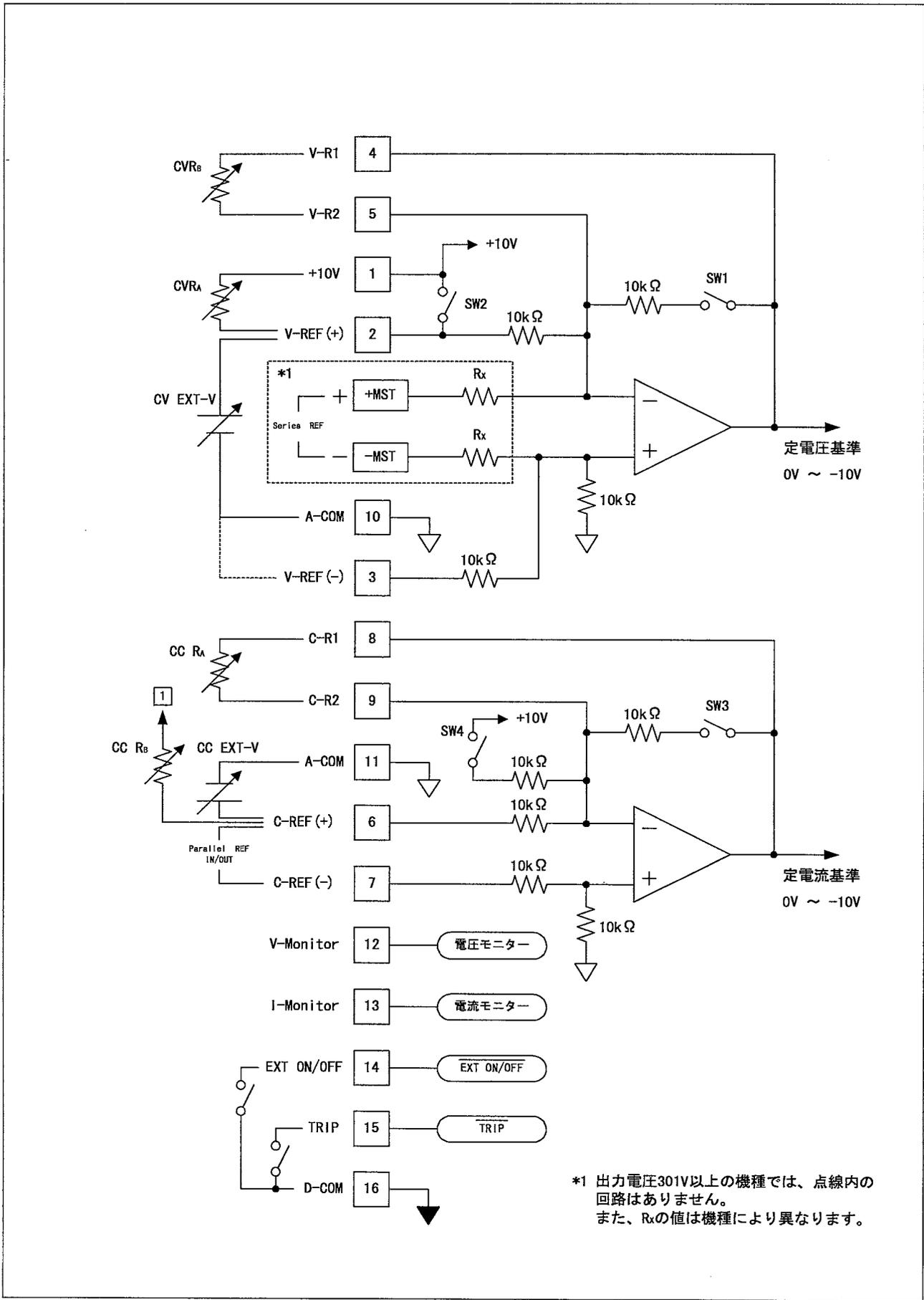
定電圧・定電流直流電源
