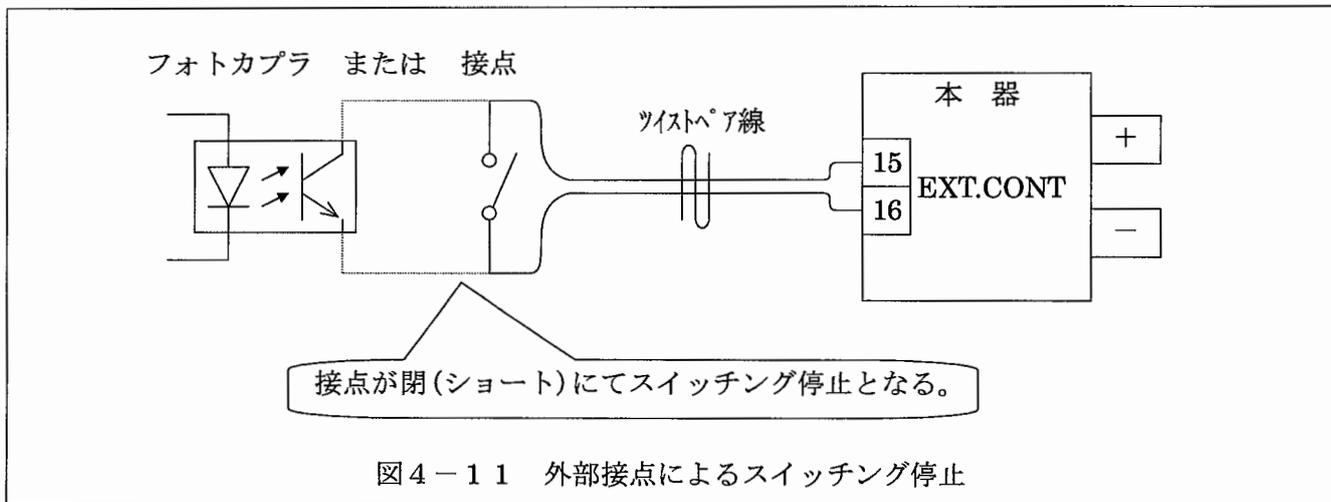
図4-11 外部接点によるスイッチング停止
