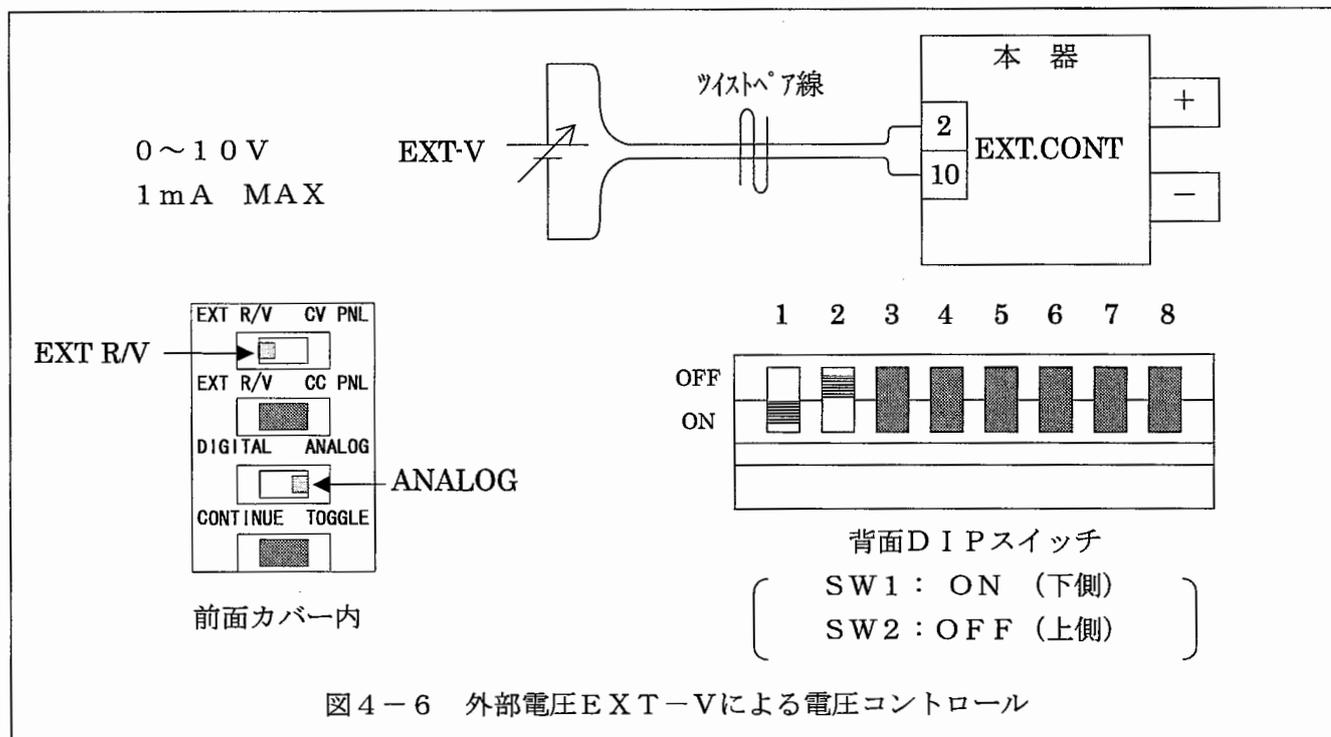
図4-6 外部電圧EXT-Vによる電圧コントロール
