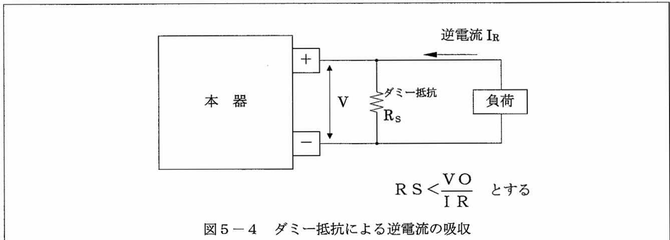
また、図5-5のようにパルス状の逆電流が流れる場合は、負荷に並列に大容量のコンデンサ（数千～数万 $\mu F$ ）を接続することで出力電圧を安定化できます。
