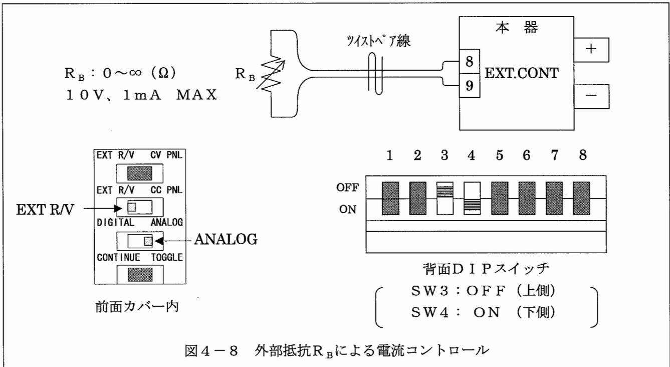
図4-8 外部抵抗 $R_B$ による電流コントロール
