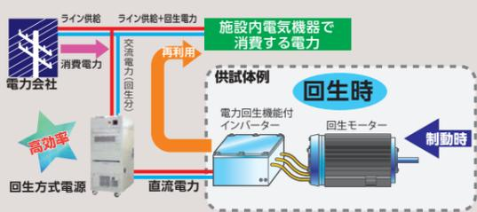
供試体に給電時は高効率直流電源として動作します。
