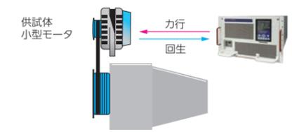
**■ DC/DCコンバータ特性試験・評価用**
