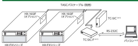
※1:TC-SICシリーズ背面の「SERIAL IF」コネクタとKX-S・KXシリーズをマルチ接続ケーブルで接続すればHX-FXシリーズと混在させ、パソコンで制御することができます。
