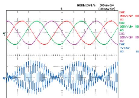
CH1:出力電圧U相 CH3:出力電圧W相
