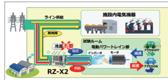
吸収した電力を熱にしないことで、放熱用の空調設備が**最小限に抑えられ**、電力の再利用で電力量を削減します。
