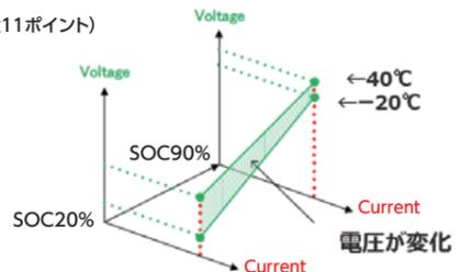
二次電池の等価回路でも設定が可能 → 設定外の動作も自動で計算して、最適な動作をシミュレート
