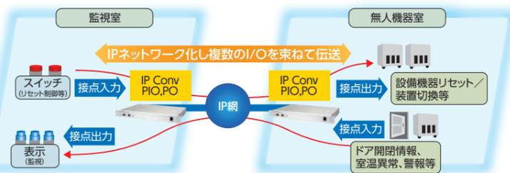
IP Converter I/O伝送 システム構成
