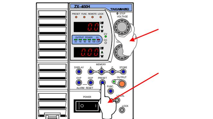
3. 「CURRENT」ツマミを回して設定値を0(直線性補正機能:OFF)にします。
