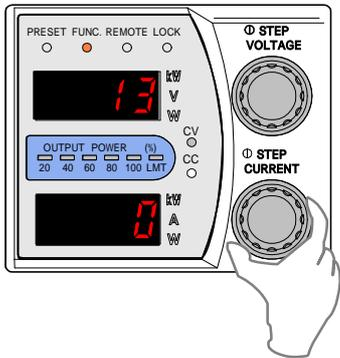
8. 電流モニター計測用デジタルマルチメーターの表示が「0.00V」になるように「CURRENT」ツマミで調整します。
