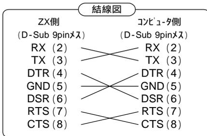
両端 D-Sub 9pin(メス)付 クロスケーブル
