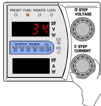
9. 「FUNC.」キーを押し、出力電流モニターのアフセット校正を終了します。
