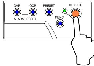
2. 「FUNC.」キーを押し「VOLTAGE」ツマミを回して「数字表示器」上段に設定項目13を表示させます。
