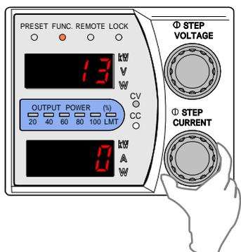
6. 再度、「PRESET」キーを押した後、「OUTPUT」キーを押し、出力をONにします。
