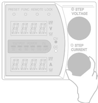
9. スレーブ機の「FUNC.」キーを押し「VOLTAGE」つまみを回して「数字表示器」上段に設定項目番号 38 を表示させます。
