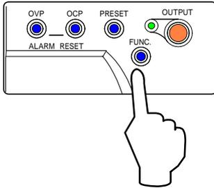
14. 「FUNC.」キーを押し、外部抵抗による出力電圧のコントロール(C)のオフセット校正を終了します。
