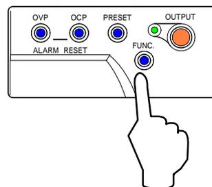
8. 「FUNC.」キーを押し「VOLTAGE」ツマミを回して「数字表示器」上段に設定項目30を表示させます。
