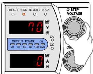
3. 「CURRENT」ツマミを回して設定値を 1 (外部電圧) に変更します。
