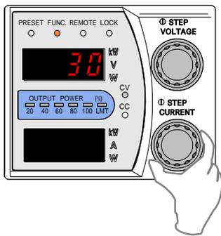
13. 出力電圧計測用デジタルマルチメーターの表示が設定値になるように「CURRENT」ツマミで調整します。設定値の求め方は「外部抵抗による出力電流のコントロール」に記載しています。
