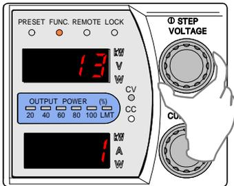
7. 「FUNC.」キーを押し「VOLTAGE」ツマミを回して「数字表示器」上段に設定項目34を表示させます。
