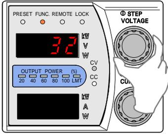
11. 「FUNC.」キーを押し「VOLTAGE」つまみを回して「数字表示器」上段に設定項目33を表示させます。
