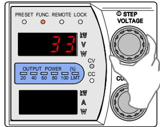
9. 「FUNC.」キーを押し、出力電圧モニターのオフセット校正を終了します。
