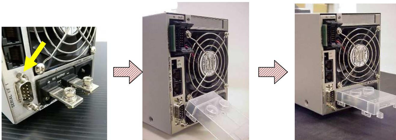
2. 端子カバーの残りの1個に固定用のサポート(端子カバーの内側センター部へ挿入)をカバー下からM3×6mmビスで固定します。
