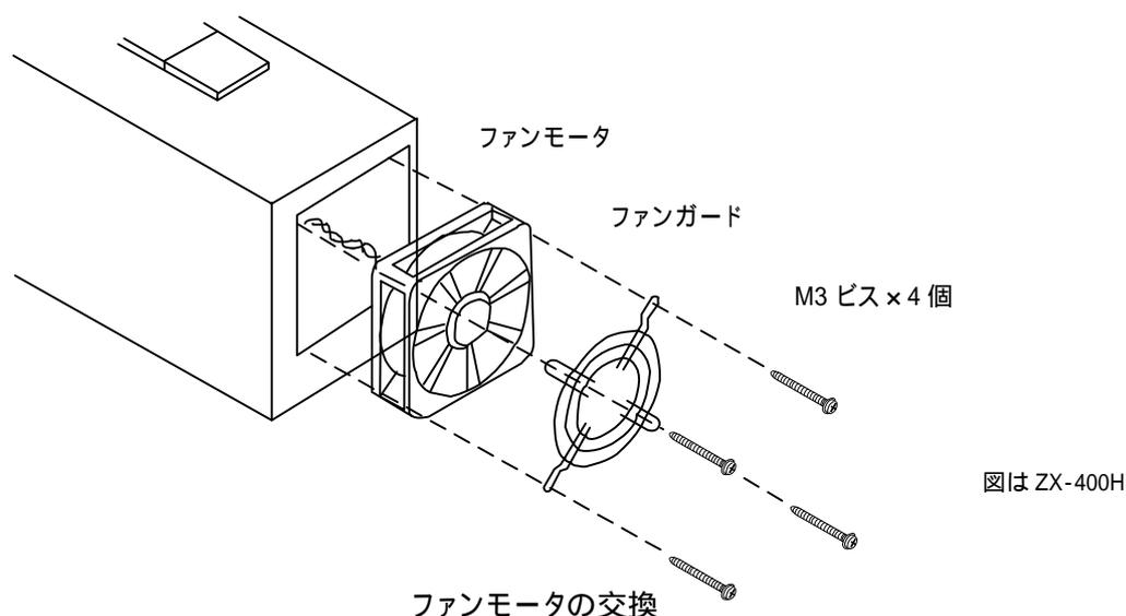
ファンモータを取り付けているM3ビス4個を外し、ファンモータを引き出します。
