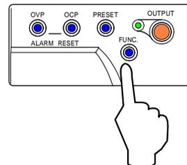
7. 「PRESET」キーを押し「VOLTAGE」ツマミにて CV 設定値を「640.0」V に設定します。
