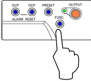
12. 「FUNC.」キーを押し、出力電流モニターのフルスケール校正を終了します。
