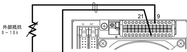
17. これで外部抵抗による出力電圧コントロール(B)のオフセット・フルスケール校正は終了です。
