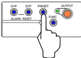
9. 「FUNC.」キーを押し「VOLTAGE」つまみを回して「数字表示器」上段に設定項目番号 23 を表示させます。
