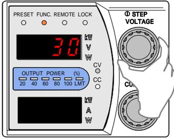
12. 「FUNC.」キーを押し「VOLTAGE」ツマミを回して「数字表示器」上段に設定項目31を表示させます。
