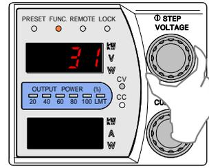
9. 出力電流計測用デジタルマルチメーターの表示が設定値になるように「CURRENT」ツマミで調整します。設定値の求め方は「外部抵抗による出力電流のコントロール」に記載しています。
