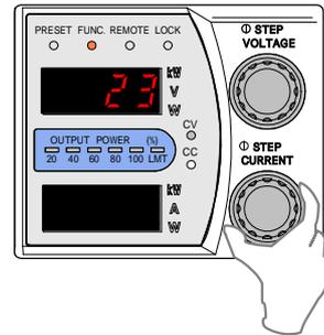
11. 「FUNC.」キーを押し、出力電流設定のフルスケール校正を終了させます。
