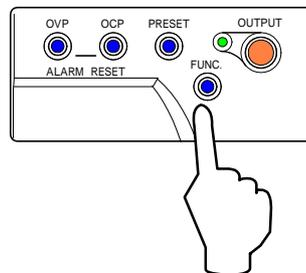
5. 「PRESET」キー を押し「VOLTAGE」ツマミ で「0.0V」に設定します。
