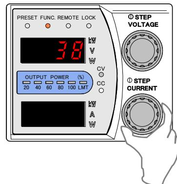
11. スレーブ機の「FUNC.」キーを押し、出力電圧設定のフルスケール校正を終了させます。
