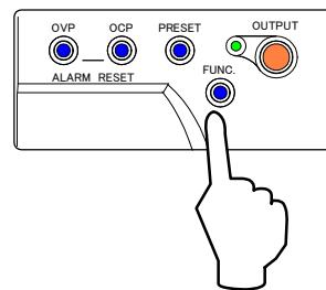
5. 「OVP」キー①を押し「VOLTAGE」ツマミ②で「88.00V」に設定します。
