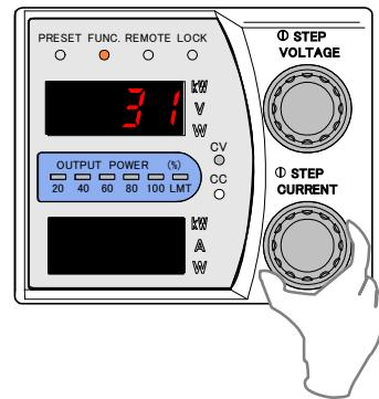
14. 「FUNC.」キーを押し、外部抵抗による出力電圧のコントロール(B)のオフセット校正を終了します。
