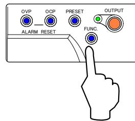
7. 「PRESET」キーを押し「VOLTAGE」ツマミにて「80.00」Vに設定します。
