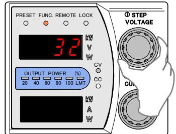
8. 電圧モニター計測用デジタルマルチメーターの表示が「0.00V」になるように「CURRENT」ツマミで調整します。
