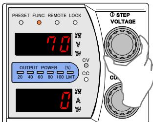
3. 「CURRENT」ツマミを回して設定値を 1(外部電圧)に変更します。
