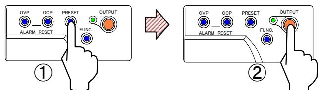
7. 「FUNC.」キーを押し「VOLTAGE」ツマミを回して「数字表示器」上段に設定項目32を表示させます。
