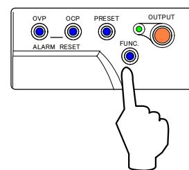
7. 「PRESET」キーを押し「VOLTAGE」ツマミにて CV 設定値を「80.00」Vに設定します。
