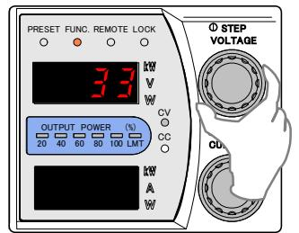
13. 「FUNC.」キーを押し、出力電圧モニターのフルスケール校正を終了します。
