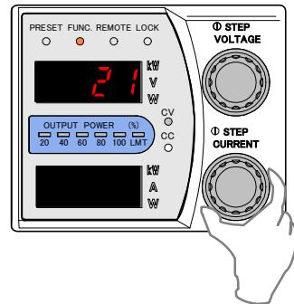
11. 「FUNC.」キーを押し、出力電圧設定のフルスケール校正を終了させます。
