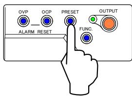
9. 「FUNC.」キーを押し「VOLTAGE」ツマミを回して「数字表示器」上段に設定項目番号 21 を表示させます。
