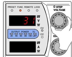
13. 出力電流計測用デジタルマルチメーターの表示が設定値になるように「CURRENT」ツマミで調整します。
