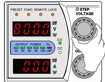
設定が完了したら、「PRESET」キーを押します。
