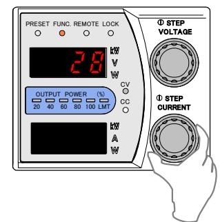
10. 「FUNC.」キーを押し、外部電圧による出力電圧のコントロールのオフセット校正を終了します。
