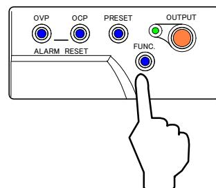
8. 「FUNC.」キーを押し「VOLTAGE」ツマミを回して「数字表示器」上段に設定項目30を表示させます。
