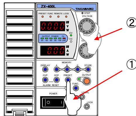
6. 再度、「PRESET」キーを押した後、「OUTPUT」キーを押し、出力をONにします。
