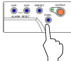
7. 「PRESET」キーを押し「CURRENT」ツマミで CC 設定値を「40.00」A(※)、「VOLTAGE」ツマミで CV 設定値を「1.00 V」に設定します。
