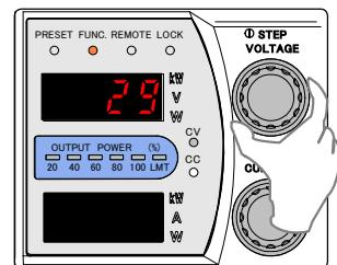
13. 出力電圧計測用デジタルマルチメーターの表示が「80.00V」になるように「CURRENT」ツマミで調整します。
