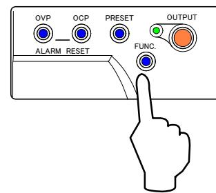
5. 「PRESET」キー①を押し「VOLTAGE」ツマミ②で「0.00V」に設定します。
