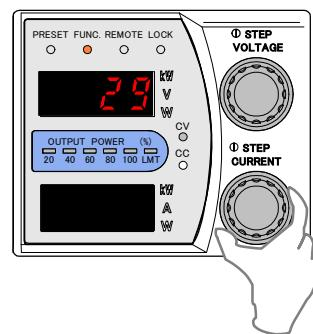
14. 「FUNC.」キーを押し、外部抵抗による出力電圧のコントロール(C)のフルスケール校正を終了します。
