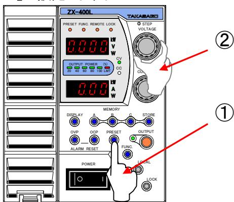
11. 「FUNC.」キーを押し「VOLTAGE」ツマミを回して「数字表示器」上段に設定項目33を表示させます。
