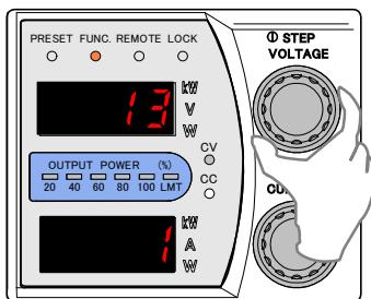
3. 「CURRENT」ツマミを回して設定値を0(直線性補正機能:OFF)にします。
