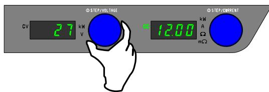
※その際「数字表示機(電流)」には電流計側値が表示されます。
