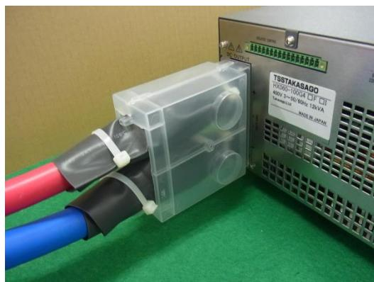
6. 出力端子カバーをM3 × 6mmビスで固定し、出力端子カバーの取り付け完了です。
