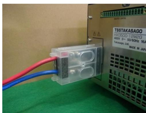
4. 出力端子カバーをM3×6mmビスで固定します。
