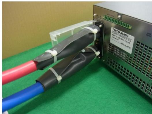
5. もう1個の出力端子カバーを出力端子の右側の溝にはめ込みます。
