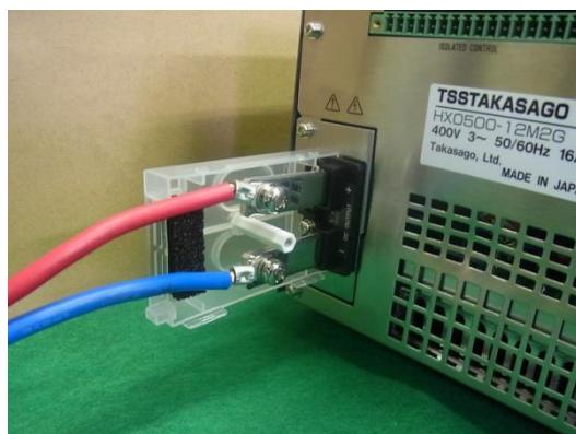
3. もう1個の出力端子カバーを出力端子の右側の溝にはめ込みます。
