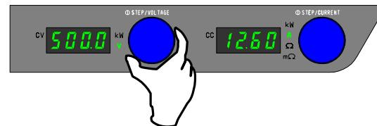
FUNCTION 項目番号 50 のパラメータが 0 のときは、再度「PRESET」キーを押してプリセット・モードから抜けたときに出力電圧が更新されます。
