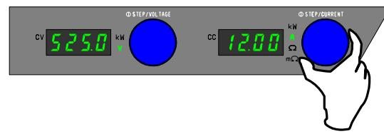
FUNCTION 項目番号 50 のパラメータが 0 のときは、再度『PRESET』キーを押してプリセット・モードから抜けたときに出力電流が更新されます。
